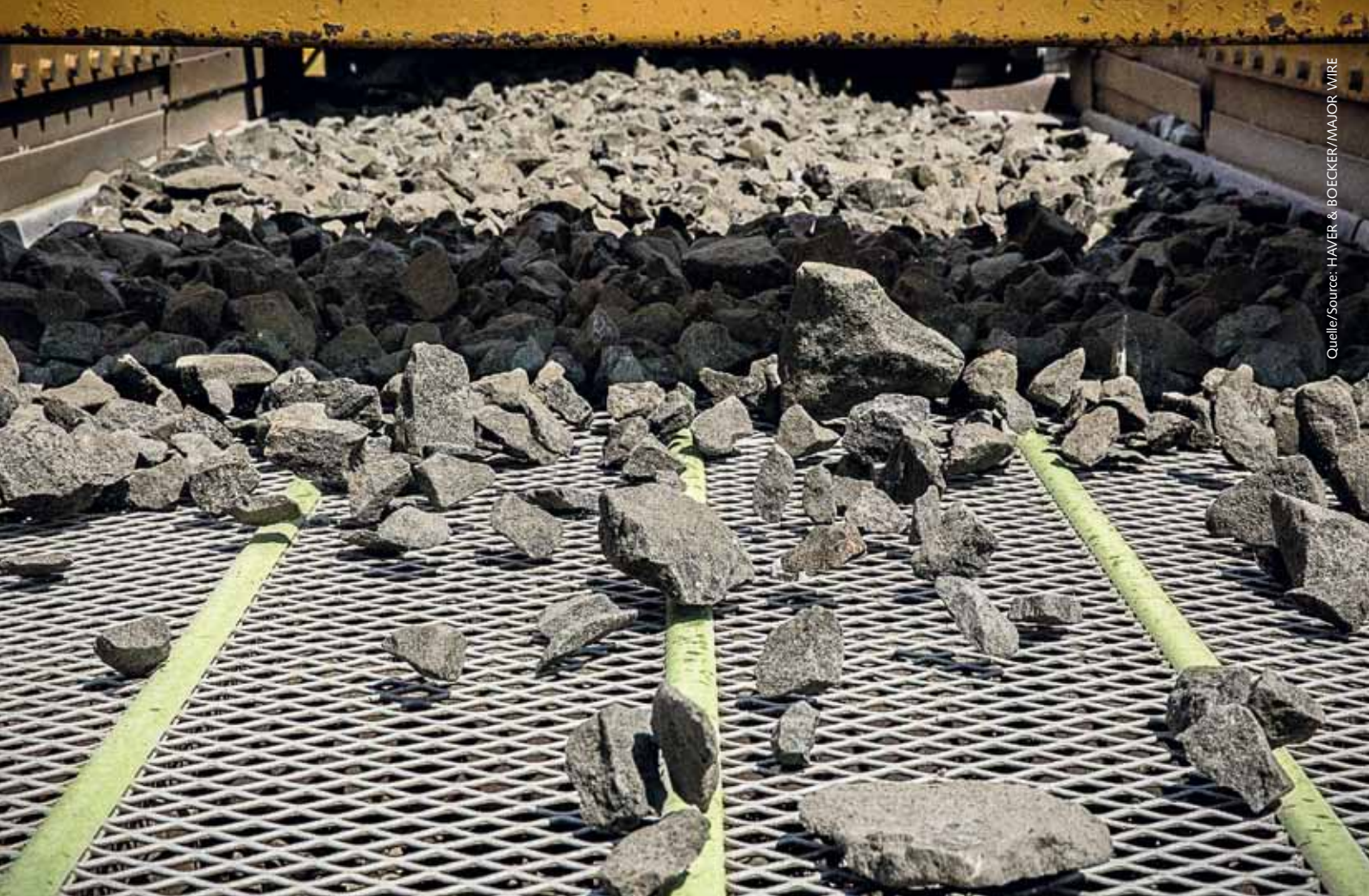
1 Siebdeck mit optimierter offener Fläche • Screen deck with optimised open area
