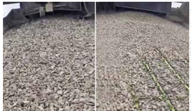
3 Zwei gleiche Maschinen mit identischem Material haben völlig verschiedene Kapazitäten durch unterschiedlich schnelle Schichtenbildung (links: Gewebe, rechts: Flex-Mat®) Two identical machines with identical material have totally different capacities due to the different speed of stratification (on the left: woven wire, on the right: Flex-Mat®)
