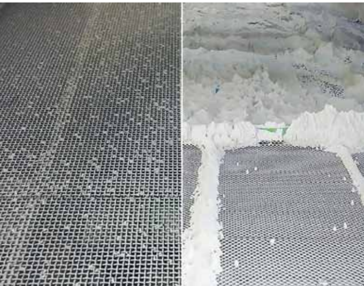
2 Steckkorn (links) und Erblindung (rechts) kann die verfügbare offene Fläche erheblich verringern • Pegging (left) and blinding (right) can substantially reduce the available open surface
