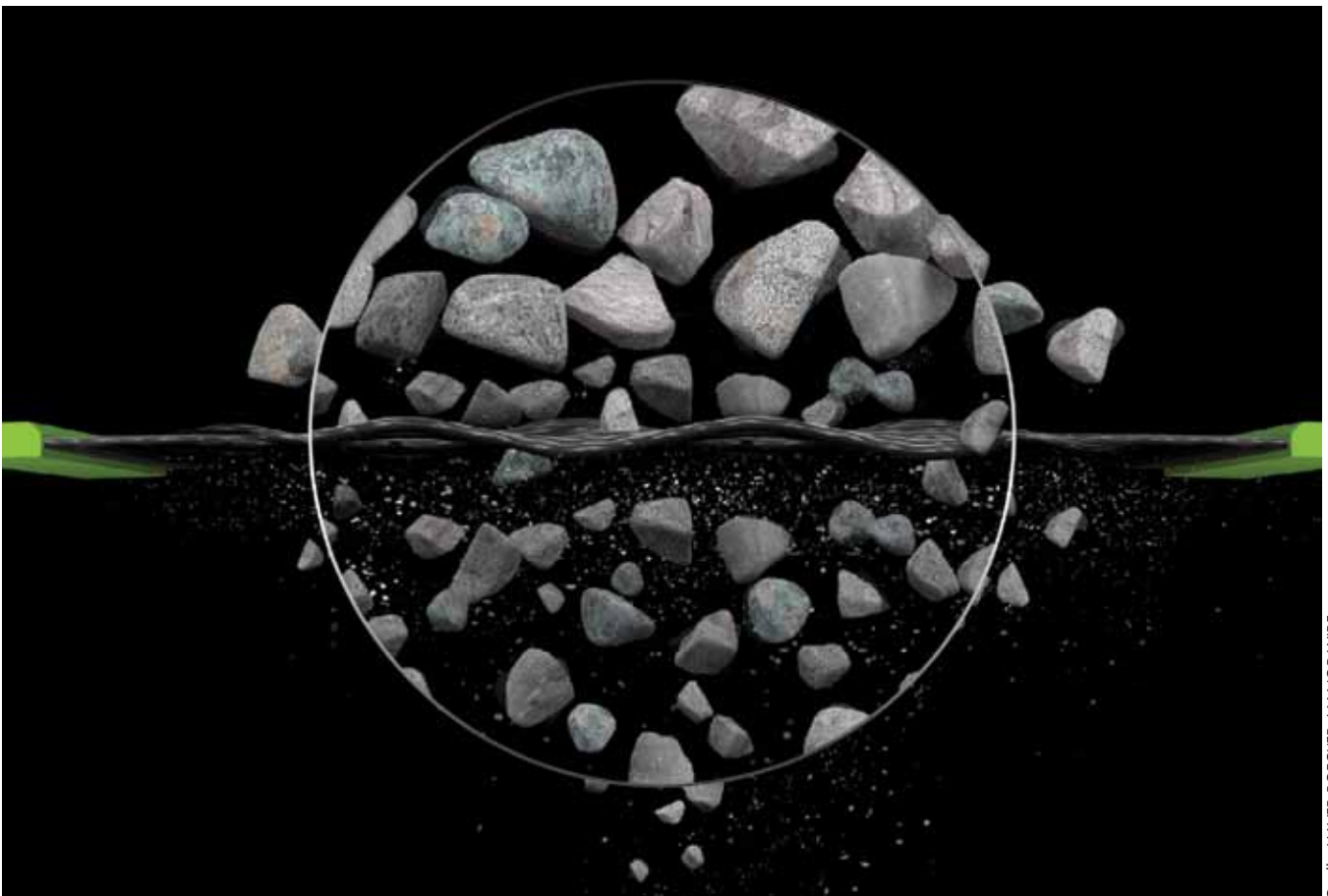
4 Die Schichtung des Materials ermöglicht es den feinen Partikeln abzusinken und zur Sieboberfläche zu gelangen. Stratification of the material allows the fine particles to settle and to reach the surface of the sieve.
